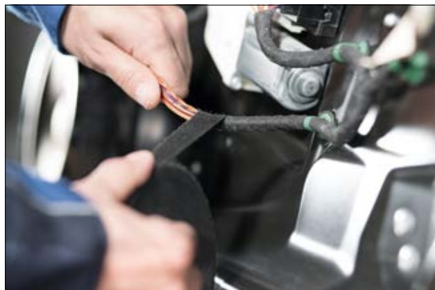
HelaTape Protect 250 är designad för kablage och ger en mycket hög resistens mot höga temperaturer.
