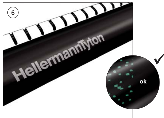
För att avgöra om hylsan har återhämtat sig helt, speciellt på översidan, kontrollera om färgfläckarna försvunnit och om den självhäftande limmet syns väl från båda ändar.
