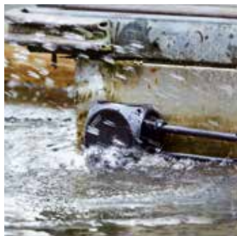
WP-serien: IP 68 nedsänkning upp till 20 meter, 168 timmar för gelfyllning, „vattentät“ metrisk utbrytningsöppningar
